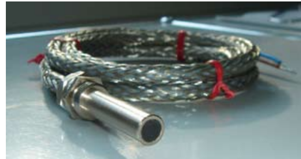
Für Eigenbedarf entwickelter induktiver Sensor aus Anfangszeiten, 1973 (Sonderausführung für extreme Bedingungen)
