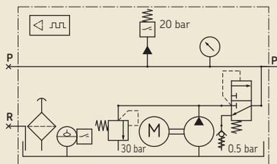
MKx-Aggregat mit 3 Liter Kunststoffbehälter für Öl, Fließfett und Öl+Luft
