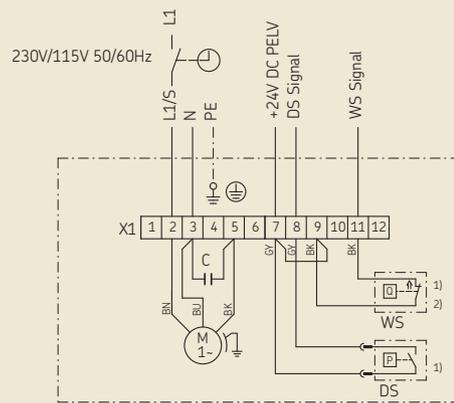
Beispiel: MKU1.. ungesteuert, 2 Kabelverschraubungen, Füllstandsschalter öffnet bei min.
