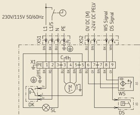
Beispiel: MKF2.. ungesteuert, mit Drucktaster DK, 2 Steckanschlüsse, Füllstandsschalter öffnet bei min.
