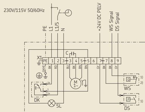
Beispiel: MKU2.. ungesteuert, mit Drucktaster DK, 2 Kabelverschraubungen, Füllstandsschalter öffnet bei min.
