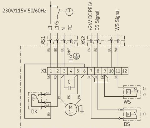
Beispiel: MKU1.. ungesteuert, mit Drucktaster DK, 2 Steckanschlüsse, Füllstandsschalter öffnet bei min.
